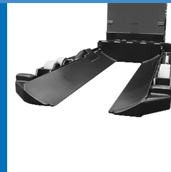
Rollentransporter eingesetzt in der Papierindustrie
